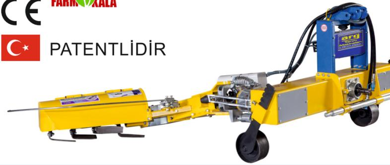
Arg 3040 bağlar ve bodur bahçeler aralarını çapalamak için ideal bir makine olup, meyve arasına 45 cm. girip çıkabilen, arazideki işçiyeye dayalı gücü aza indiren bir makinedir.
